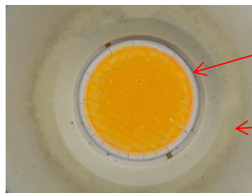
图 17. 使用树脂支架时的外观（10000hr 连续亮灯后的 COB 和支架）
